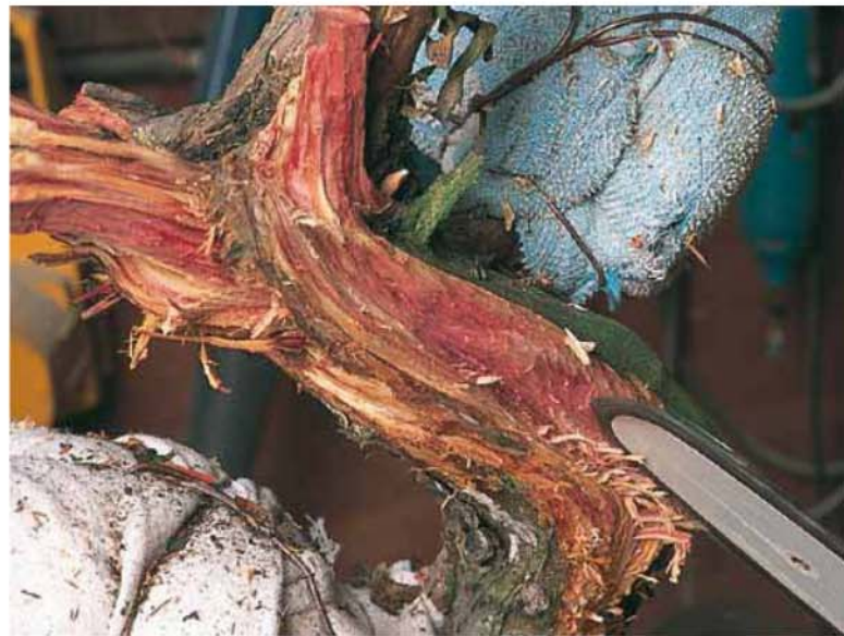
(10) Da unos ligeros golpes con la sierra eléctrica. Para que la herramienta desbaste la madera. En realidad de la manera que el trabaja, rompe más que corta.
