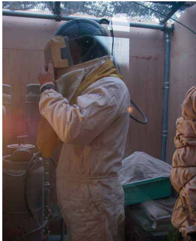
Preparándose para el trabajo con arena. Hay que protegerse bien para no respirar el polvo durante el trabajo.
